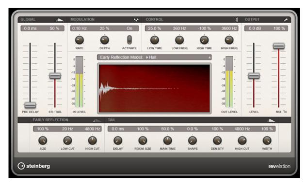
早期反射负责在混响的最初几毫秒内营造空间印象。可选择不同的早期反射模式并调整其大小,以模拟不同的室内空间。混响尾音(即晚期混响)提供控制室内空间大小和混响时间的参数。可在3个频段单独调整混响时间。
