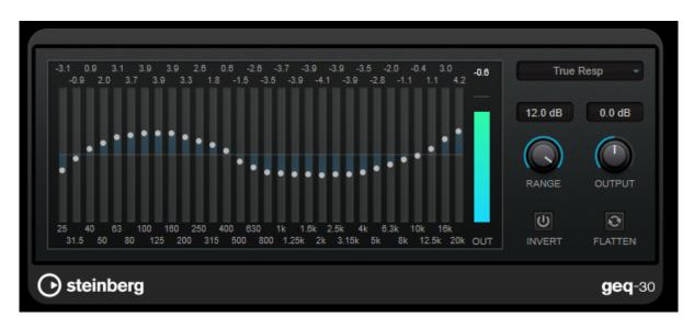
每个频段最多可衰减或提升12dB,因此可对频率响应进行精细控制。此外,还可使用几种预设模式,为GEQ-30的声音增添色彩。
