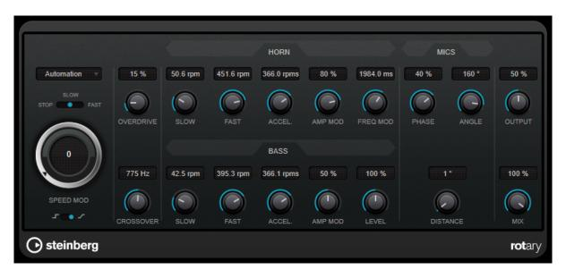
旋转扬声器箱体的特点是扬声器按不同的速度旋转以产生漩涡式合唱效果,通常用于风琴。
