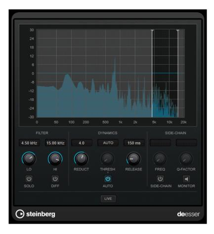
例如,可在如下情况下使用:接近麦克风和进行均衡处理后,整体声音恰到好处,但出现不需要的咝声。录制声音时,DeEsser在信号链中的位置通常在麦克风前置放大器之后且在压缩器/限幅器之前。如此,压缩器/限幅器可以避免对整个信号的动态进行不必要的限制。
