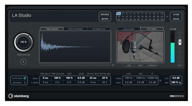
这是通过根据脉冲响应处理音频信号来实现的。脉冲响应是在室内空间或其他地点录制的,再现了室内空间的特性。因此,经过处理的音频听起来像在同一地点演奏一样。插件中包含真实空间的最高质量的样本,用于制作混响。
